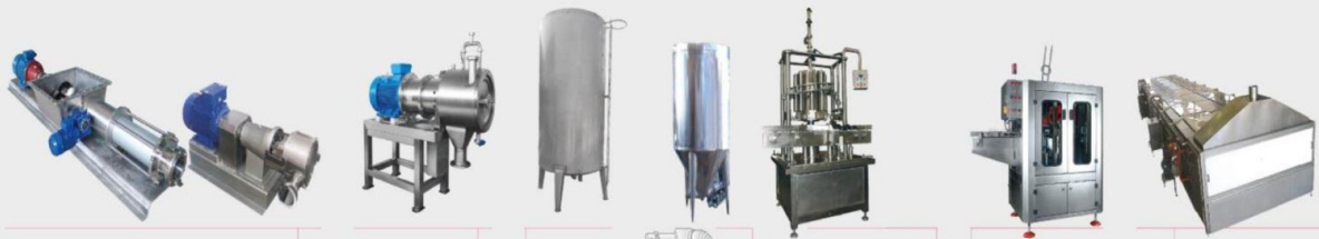
ТAYMAZ infographic Монопомпа и размельчитель 3 Турбо фильтр 5 6 Запасной резервуар 8 Емкость добавление соли 10 11 Наполнитель Закупорка крышек 12 Туннель пастеризатора
